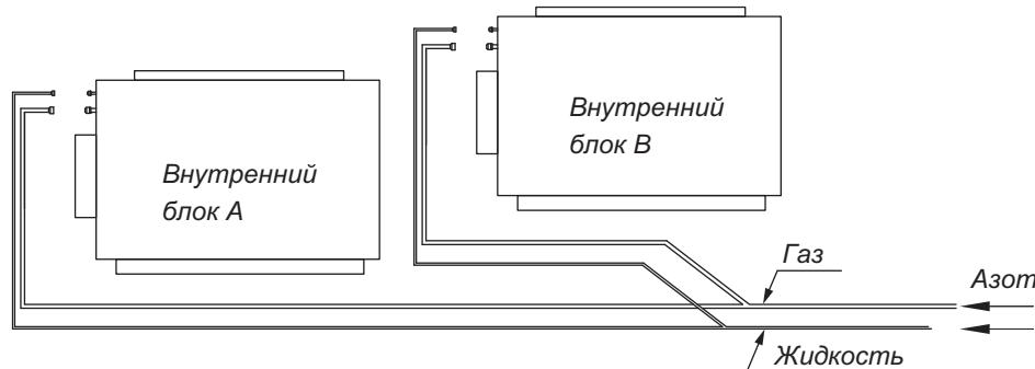
Шаг 2: Установите насадку на жидкостную трубу системы и подсоедините к ней шланг высокого давления манометрического коллектора, установленного на резервуар с азотом.
