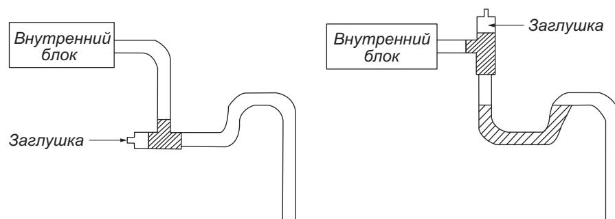
Все дренажные трубы должны быть проложены на расстоянии не менее 500 мм от электрической коробки внутреннего блока, чтобы обеспечить возможность технического обслуживания. Если пространства не достаточно, итоговое размещение дренажной трубы должно определяться монтажниками, производящими установку и обслуживание системы.
