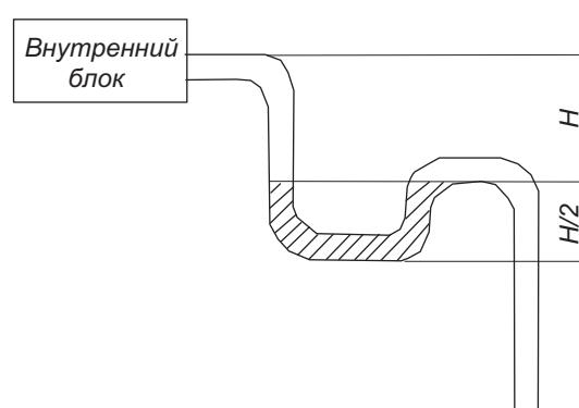
Чтобы обеспечить возможность промывки дренажной трубы установите заглушку рядом с гидрозатвором.
