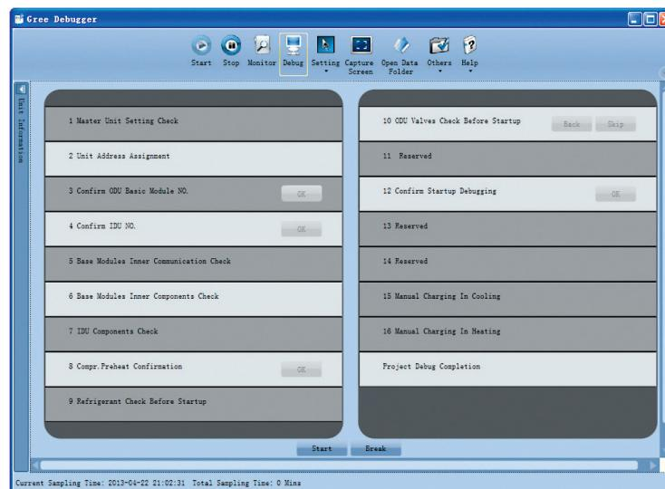
**Шаг 7:** Нажмите кнопку **Start**, чтобы начать отладку системы. На дисплее ПК рядом с текущей процедурой отображается иконка , а рядом с уже выполненными процедурами — .
