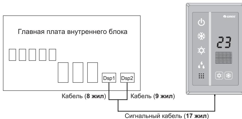
Проводной пульт управления и приемник ИК-сигнала могут использоваться одновременно.
