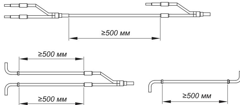
Крепление разветвителей: и при горизонтальной, и при вертикальной установке разветвители крепятся в трех точках:
