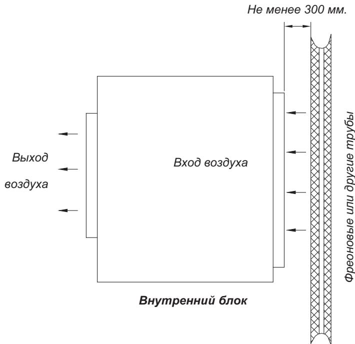
Если фреоновые трубы требуется проложить со стороны выхода воздуха из блока, не рекомендуется располагать их непосредственно напротив воздуховыпускной решетки. Фреоновые трубы не должны касаться никаких элементов внутренних блоков за исключением мест соединения. Нарушение перечисленных правил может привести к снижению производительности и повышенному шуму.
