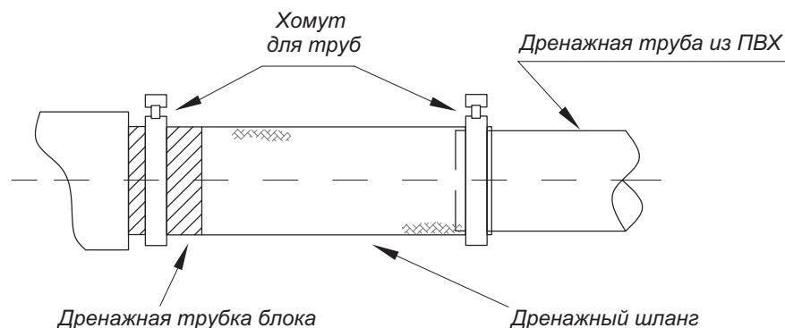
Дренажная труба должна быть теплоизолирована, чтобы предотвратить образование конденсата на ее поверхности.
