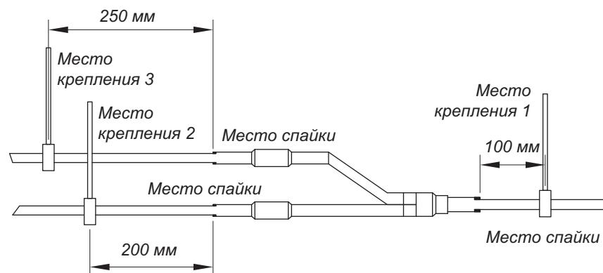
Разветвители жидкостной и газовой труб должны располагаться параллельно друг другу. Жидкостная и газовая трубы должны прокладываться совместно и иметь одинаковую длину.
