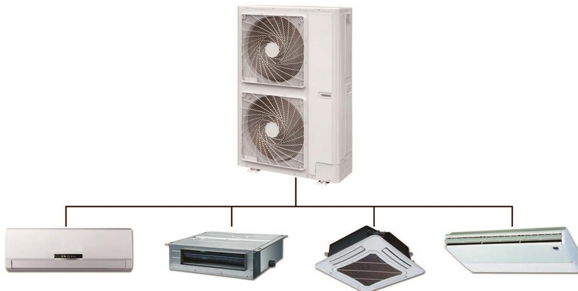
К одному наружному блоку может быть подключено не более 20 внутренних блоков. Суммарная номинальная мощность внутренних блоков должна быть в пределах 50–135% от номинальной мощности наружного блока.
